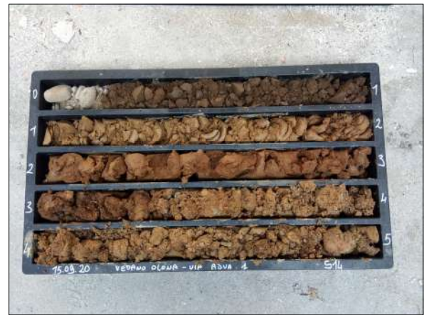
Sondaggio S14 da 0,0 m a 5,0 m da p.c.
