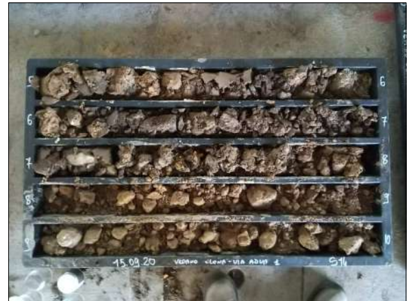
Sondaggio S14 da 5,0 m a 10,0 m da p.c.
