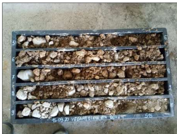
Sondaggio S15 da 5,0 m a 10,0 m da p.c.
