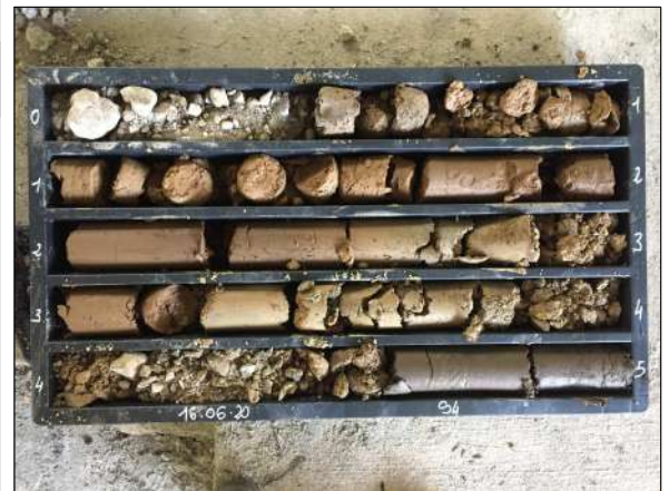
Sondaggio S4 da 0,0 m a 5,0 m da p.c.
