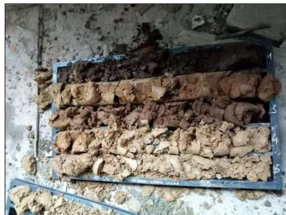
Sondaggio S5 da 0,0 m a 5,0 m da p.c.
